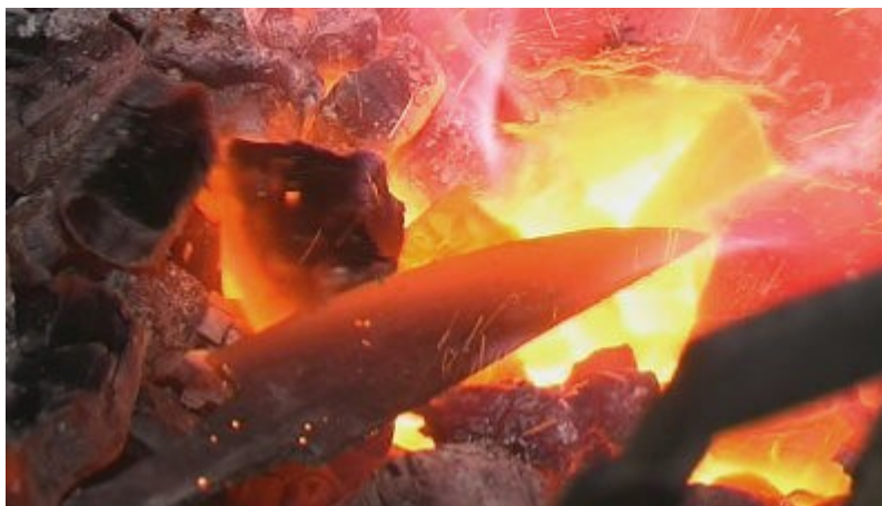
Puukonterän karkaisu ahjossa siten, että vain teränsuu lämpenee riittävästi ja karkenee
